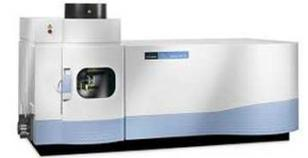
L'analyse élémentaire avec un ICP permet un référencement quantitatif de constituants majeurs (charges, composants semi-organiques...), mineurs ou de traces (pollution...). Plus de 50 éléments analysables, limite de détection très basse (ppb).
