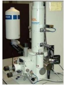
L'analyse par Microscopie électronique permet de mesurer des dimensions de couches de fibre et de couches de vide (vue en coupe d'un non tissé) et d'identifier des fibres de nature différente (ici cellulose et verre) de manière étudier leur répartition et leur dimensions (vue de face d'un non tissé).
