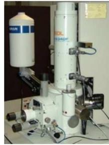
Un des fléaux qui touchent les circuits imprimés sont la présence de micro-particules conductrices qui peuvent occasionner des dégâts irréversibles sur les composants. L'analyse MEB/EDX permet rapidement de localiser et d'identifier la nature de particules (ici particules d'Aluminium et d'Or).
